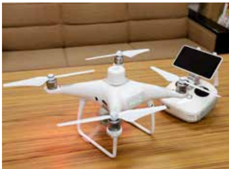
災害調査・研究に使用しているUAV：DJI社 Phantom 4 RTK。基地局とリアルタイムで通信することで、位置情報を持った航空写真データが取得でき、高精度の地形データ作成が可能。
